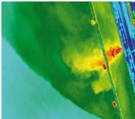
Interprétation informatique d'une photographie infrarouge de rejets industriels. On constate que la digue est défectueuse et laisse passer les rejets sous la masse béton.
